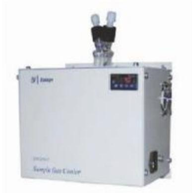
가스분석기를 연속으로 사용하기 위하여 샘플 가스를 냉각하여 수분을 응축한 후, 수분과 건조 가스를 분리하며, Drain Pump 를 사용하여 수분을 배출하고 건조한 가스를 분석기로 보냄 으로서 센서의 수명을 보장하고 정확한 측정을 위한 Peltier 방식의 기수 분리장치이다.
